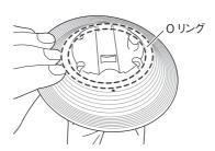
⑥提灯シェードとトップカバーの三角マークどうしが合うようにトップカバーを被せ、トップカ バーを回して取り付けてください。
