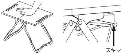
ゆっくりと天板を開いたら、天板裏側のストッパーが働いているか、地面に設置した状態で、上方向から天板を軽く押し確認してください。同時に天板の傾きもこの方法で調整してください。なお天板裏面のパネと金具にスキマができる場合があります。その際は4箇所のスキマが均等になるように調整してください。
