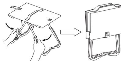
※収納の際は、必ず支柱を天板から外してください。支柱はセット方法と逆の順序で取り外してください。
