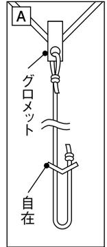
タープは上図の様にテントの前室に少し重なるようにセッティングします。まずは、2mロープと3mロープを①にならって取付け、準備をし、下の手順で設営してください。
