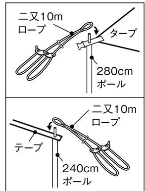
① タープをテントの脇に広げ、コネクションテープを固定①、テント前室に少し重なるよう意識しながらタープの長さをアジャスターを使い調整②する。アジャスターを地面に向けて取付けると設営後に調整しやすくなります。
