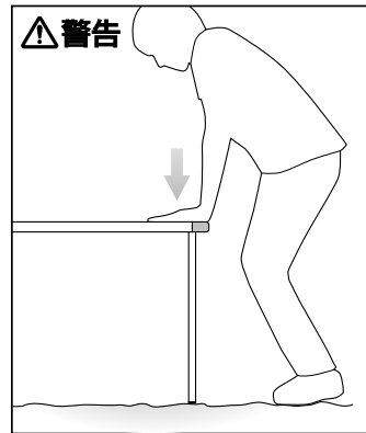
⚠ 警告 フレーム部に体重をかけないでください。転倒の原因となります。
