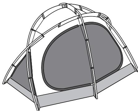
④ フレームに付いているプラスチックフックをすべて取りはずした後、センターフレーム、ダブルクロスフレームの順にフレームをインナーテントから抜き取ってください。
