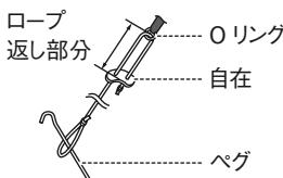
ロープの自在が付いている返し部分がOリング側に来るよう取り付けてください。
