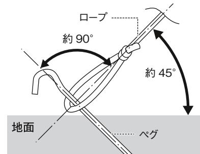
ペグダウンはテントからできるだけ遠くに行ってください。設営したとき、ロープの角度が地面に対して約45°となるのが理想的なペグダウンの位置です。また、ペグを打ち込む角度はロープに対して90°になるようにペグダウンしてください。
