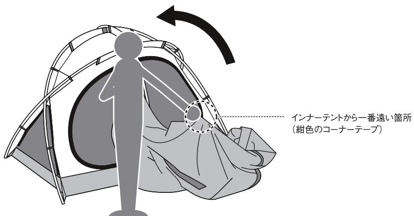
⑫ フライシートの内側に付いているずれ防止のベルクロテープをフレームに巻きつけて固定してください。(10カ所)
