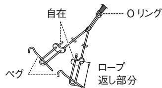
中間の結び目をOリングに通し返し部分がペグ側に来るよう取り付けてください。
