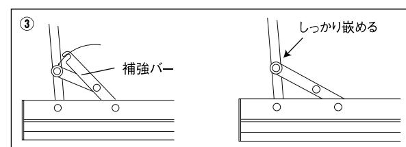
上図の補強バーをセットします。(4箇所)
