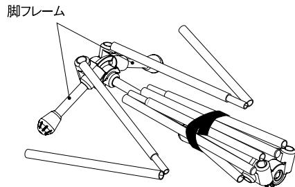
③ハンギングフレーム(上)(下)を接続し、ジョイントを差し込みます。
