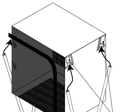
⑥メッシュボックスのファスナーを開き、金網を下段から取り付けていきます。下段の金網はメッシュボックスの底面に置いてください。
