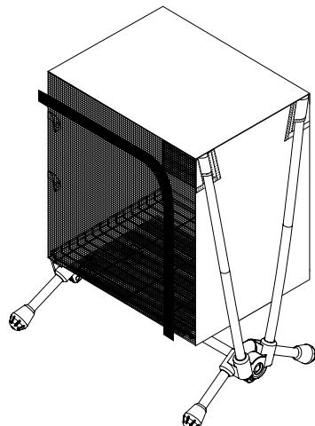
⑦中段、上段の金網はメッシュボックスのスナップボタンに固定します。
