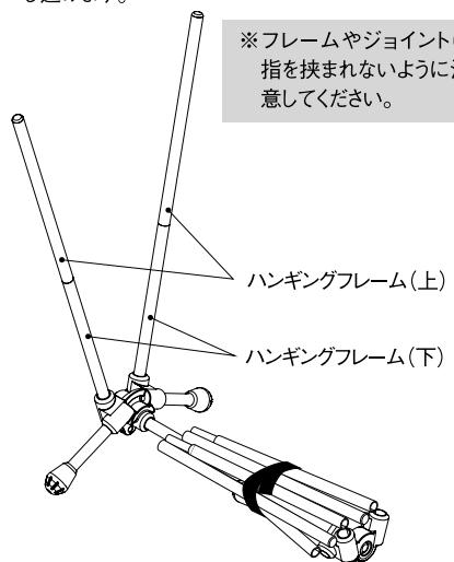
④もう一方のベルクロをはずし、①～③と同じ手順で脚フレームとハンギングフレームを組み立てます。
