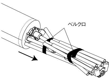
②ベルクロの片側をはずし、脚フレームをジョイントに差し込み、脚フレームを地面に設置します。
