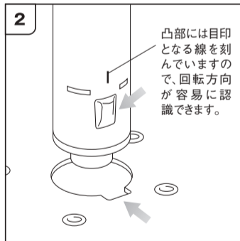
四隅にある脚固定用穴に脚パイプの凸部を合わせて差込みます。(その時、脚パイプ先端のボスが反対側に突き出たことを確認してください。)
