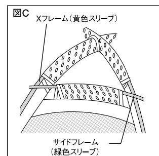
6) Xフレームの先端にピンを差し込みます。(Xフレームのコーナーテープは黄色です。)
