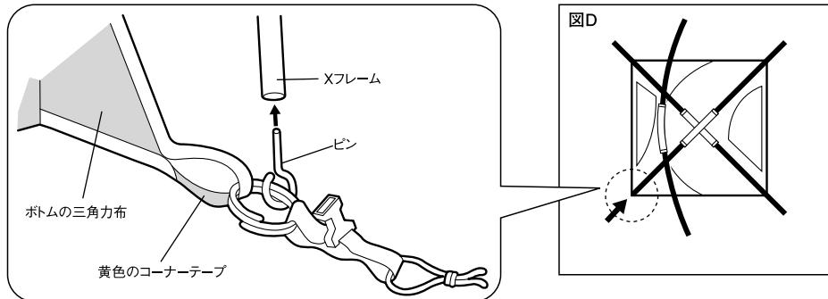
7) 差し込んだXフレームの反対側の先端にピンを差し込みます。[図E]
