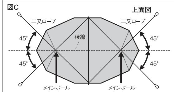
※それぞれのロープ間の角度が90°以上広い位置でペグダウンするとポールにテンションが伝わらず、正しく設営する事ができなくなりますので注意してください。ペグダウンはタープからできるだけ遠くに行ってください。設営した時、ロープの角度が地面に対し約45°となるのが理想的なペグダウンの位置です。[図D]また、ペグを打ち込む角度はロープに対して90°になるようにペグダウンします。[図E]
