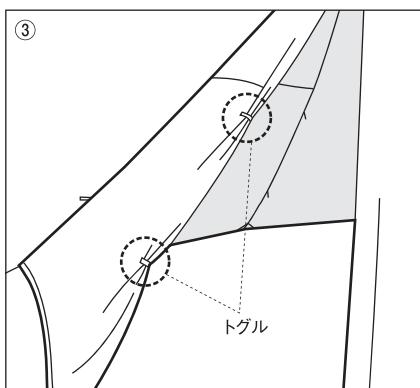
※ドアパネルとして使用する際、引き手(黒)のジッパーから、引き手(赤)のジッパーまでのパネルは、余分なパネルとなりますのでこの部分は、トグルで巻き留めて使用してください。
