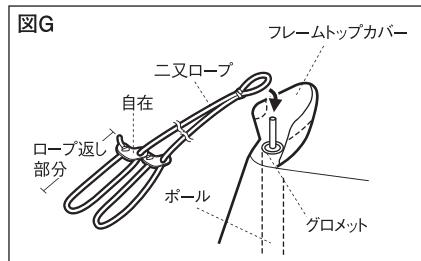
7) ロープを掛けた後、フレームトップカバーで、フレーム先端を覆うようにベルクロでしっかりと留めます。[図H]
