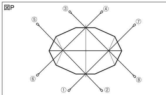
※ロープの引き過ぎにご注意ください。強く引きすぎている場合はその方向に大きなしわが発生します。しわの出ている方向のロープを緩めて、全体のテンションバランスを調整してください。
