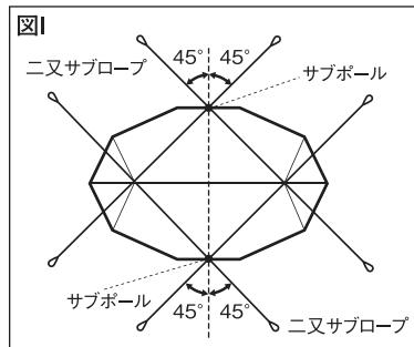
※それぞれのロープ間の角度が90°以上広い位置でペグダウンするとポールにテンションが伝わらず、正しく設営する事ができなくなりますので注意してください。ペグダウンはタープからできるだけ遠くに行ってください。設営した時、ロープの角度が地面に対し約45°となるのが理想的なペグダウンの位置です。[図J]また、ペグを打ち込む角度はロープに対して90°になるようにペグダウンします。[図K]
