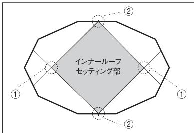
②部分の取付けは、サブポール先端をインナールーフのゴムループ付グロメットに差し込んでから サブコーナーグロメットに差し込みます。[図R]
