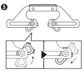
ロックピースをセットし、上図の状態にします。 両ハンドルのロック -ス、計4ヶがセットされている事 を必ず確認してください。
