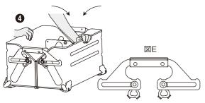
本体の両端(ボックス)を手で持ち、スライドピンが図E の状態になるまで、本体を閉じます。
