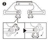
4ヶ所のロックピースを解除し、ハンドルをト 図の状態にします。ロックピースがしっかりと 下がっていない場合、本体の開閉時に部品が干渉しますので、注意してください。
