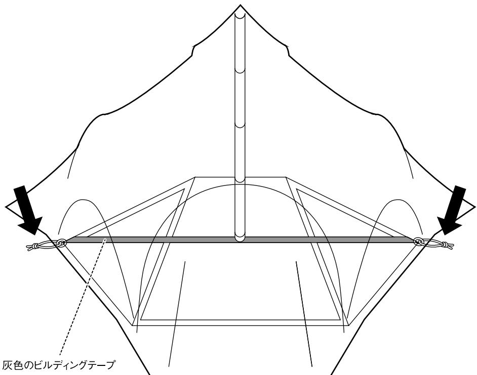
⑥フレーム長×3、フレーム短×3を組立てます。フレームは各接続部にすき間のないよう確実に組立ててください。
