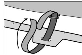
底部コネクションパーツのオス側(図中①)を底部コネクションホール(図中②)に通し、底部コネクションホールのメス側(図中②)に接続します。
