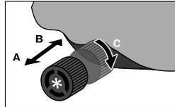
バルブをA方向に引いた状態にすると解放している状態になり、空気が自動的に入ります。バルブをB方向に押した状態にすると閉じた状態になり、さらにC方向へ回しバルブ上下についている目印を合わせた状態でロックになります。※確実にロックしたことを確認してご使用ください。
