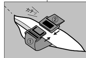
上部コネクションパーツのオス側(図中①)とメス側(図中②)を接続します。
