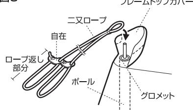
7) ロープを掛けた後、フレームトップカバーで、フレーム先端を覆うようにベルクロでしっかりと留めます。〔図H〕
