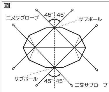
※それぞれのロープ間の角度が90°以上広い位置でペグダウンするとポールにテンションが伝わらず、正しく設営する事ができなくなりますので注意してください。ペグダウンはタープからできるだけ遠くに行ってください。設営した時、ロープの角度が地面に対し約45°となるのが理想的なペグダウンの位置です。〔図J〕また、ペグを打ち込む角度はロープに対して90°になるようにペグダウンします。〔図K〕
