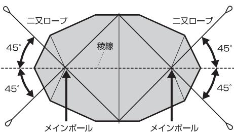
※それぞれのロープ間の角度が90°以上広い位置でペグダウンするとポールにテンションが伝わらず、正しく設営する事ができなくなりますので注意してください。ペグダウンはタープからできるだけ遠くに行ってください。設営した時、ロープの角度が地面に対し約45°となるのが理想的なペグダウンの位置です。〔図D〕また、ペグを打ち込む角度はロープに対して90°になるようにペグダウンします。〔図E〕
