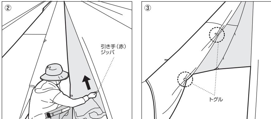
※ドアパネルとして使用する際、引き手(黒)のジッパーから、引き手(赤)のジッパーまでのパネルは、余分なパネルとなりますのでこの部分は、トグルで巻き留めて使用してください。
